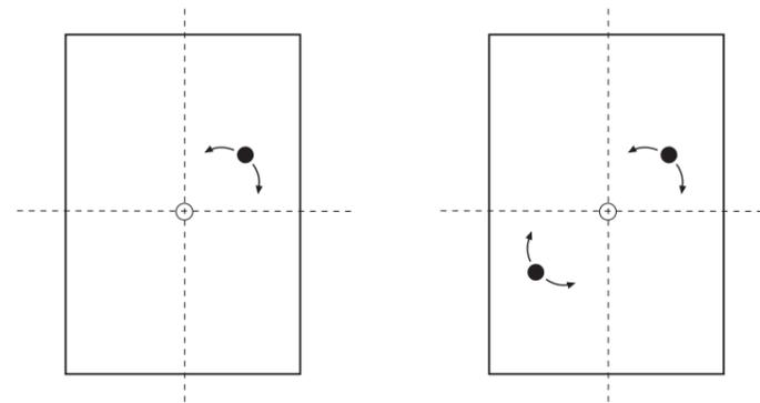
1ドロップと2ドロップのPRONTOシステムのピッチ位置は、完全に柔軟で、射出ポイントの周囲で回転できます。
