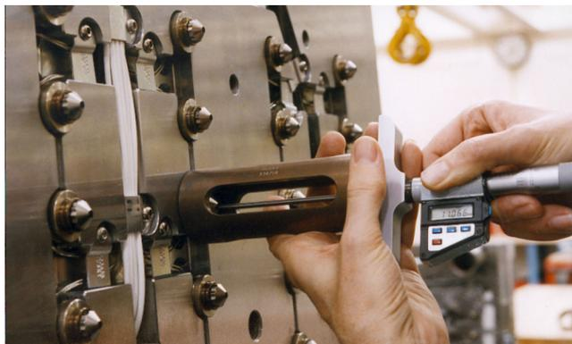
**Figure 6-96 : Mesure de la hauteur de la pointe de buse**
