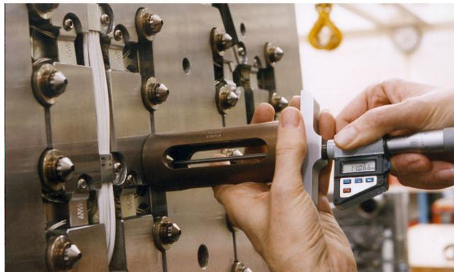
**Figura 6-41: Medição da altura do bico de injeção**
