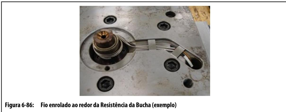
**Figura 6-86: Fio enrolado ao redor da Resistência da Bucha (exemplo)**
