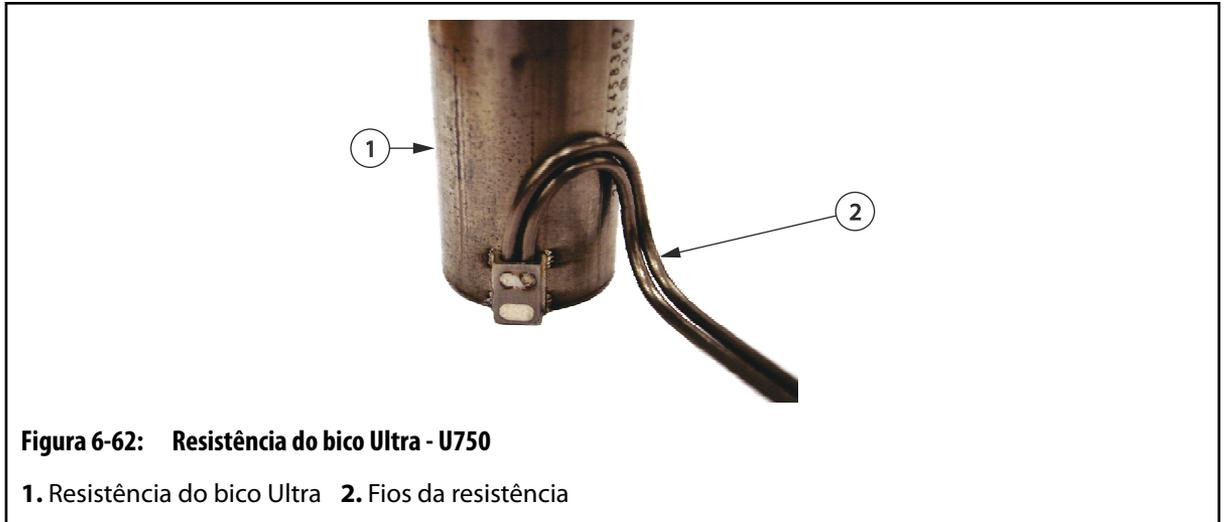
6. Nas resistências U500 , primeiro dobre os contatos ao longo da curvatura da resistência e dobre-os para cima ou para baixo (longe do contato de saída do corpo da resistência) para atender ao canais de fios da placa do manifold conforme necessário.
