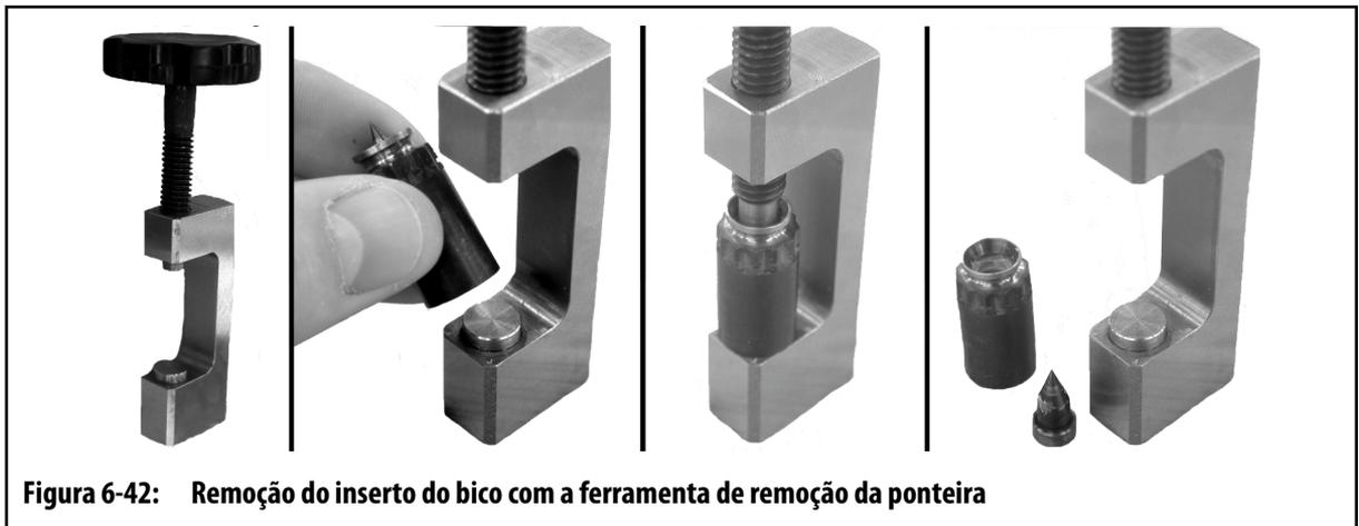
**Figura 6-42: Remoção do inserto do bico com a ferramenta de remoção da ponteira**
