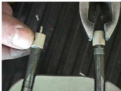
**Figura 6-88: Remoção e instalação das buchas de PEEK**
